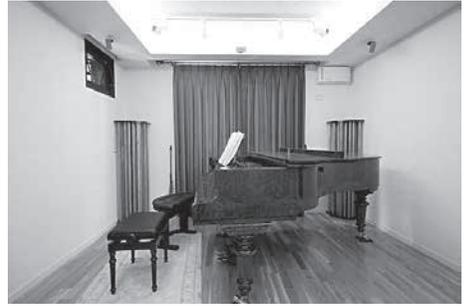
ハウスメーカー様の設計施工による木造住宅の1Fにピアノ練習室を施工しました。ピアノ演奏が深夜にもなるとのことで、外部はもとより、隣室や同じ住居内での防音性能にも配慮した設計になっています。また、響きの質とピアノの個性を引出す部屋を、との施主様のご要望に伝えるため、部屋コーナー2箇所に柱状音響拡散機構ANKHを設置しました。低音域から高音域までの響きが整った、演奏しやすい部屋になったとの評価をいただきました。
