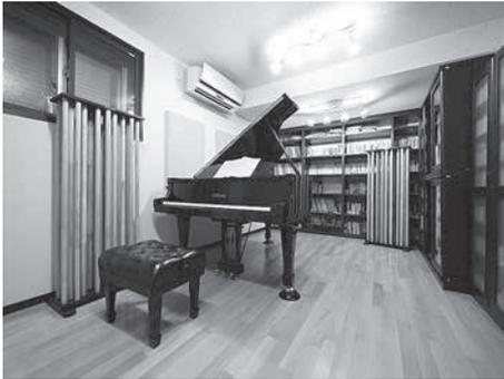
閑静な住宅街の一戸建新築時にピアノ練習室を施工しました。国際的に活躍するピアニストでもある施主様からは、防音性能に加えて、響きの質に対するご要望をいただいたことから、完成時にご本人にピアノを弾いていただき、響きの違いを確かめながら音響調整を行いました。柱状音響拡散機構ANKHで響きの質を高めたことで、練習室でありながら空間が広く感じられ、練習時でもコンサートホールと同じような弾き方で同じような響きを感じられる空間になったとの評価をいただきました。
