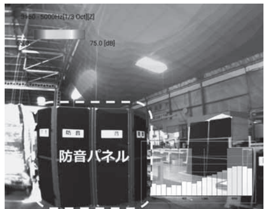
図8-2 可視化結果(防音パネル設置後)
