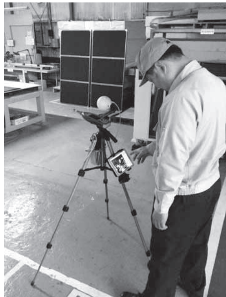
図6 防音パネルの効果を騒音計とタブレットPCで確認
