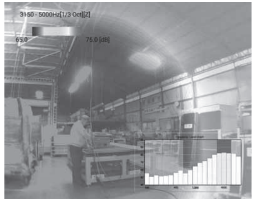
図8-1 可視化結果(防音パネル設置前)
